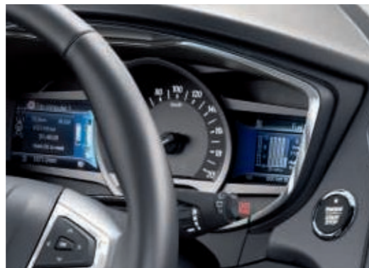
Instrumententafel mit zwei 10,7 cm LCD-Farbdisplays (nur i. V. mit 2,0-l-Ti-VCT Hybrid)
